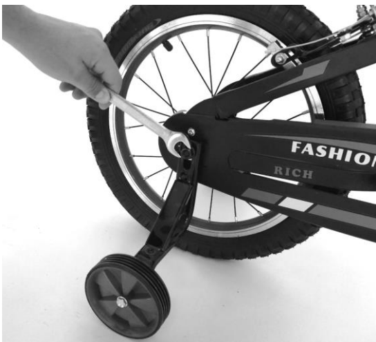
3. Scoateti piulitele cu ajutorul unei chei de 15.
