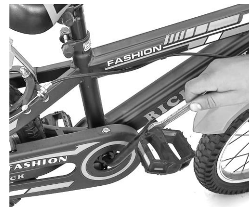
5. Insurabati pedalele cu ajutorul unei chei de 15, tinand cont de marcajele din interiorul filetului. R=dreapta, L=stanga.
