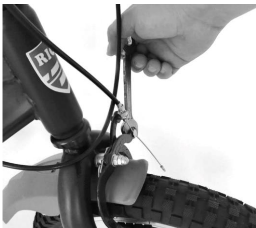
6. Fixati sabotii paralel cu janta cu ajutorului unei chei de 10.
