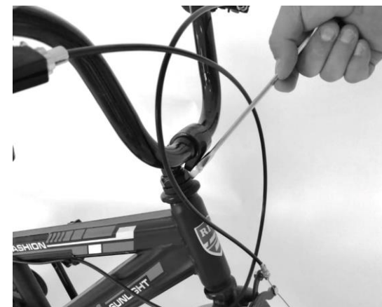
7. Fixati ghidonul in pozitie dreapta, iar apoi strangeti cu ajutorul unor chei de 12 si de 13.
